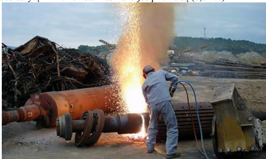
5.7. Pav. Stambių metalo laužo konstrukcijų smulkinimas pjaustant dujomis
